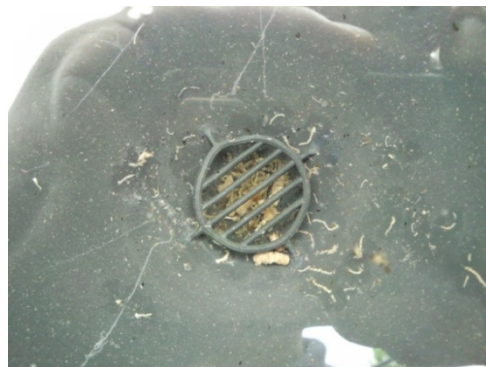
สาเหตุ: มูลแมลงอุดตันรูน้ำ ผลการวัด: วัดข้อมูลไม่ได้
