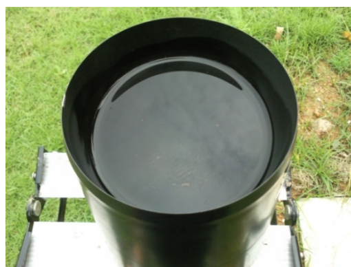
สาเหตุ: สิ่งปฏิกูลอุดตันรูน้ำ ผลการวัด: วัดข้อมูลไม่ได้
