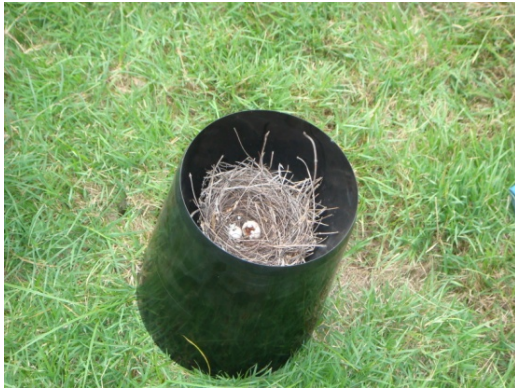
สาเหตุ: นกทำรังในถังวัดน้ำฝน ผลการวัด: วัดข้อมูลไม่ได้
