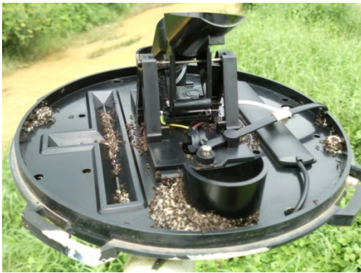
สาเหตุ: มดทำรังบริเวณส่วนล่าง ผลการวัด: วัดข้อมูลผิดพลาด
